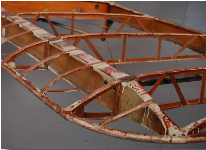
Struktur sayap pesawat yang berongga rentan terhadap retakan. Sumber: www.penggagas.com
